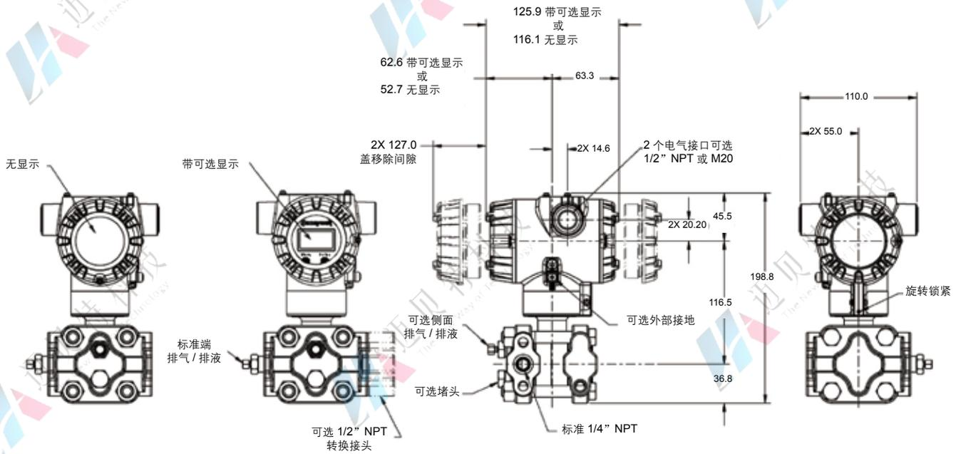
图 4 STA725 和 STA745 的典型安装尺寸图
